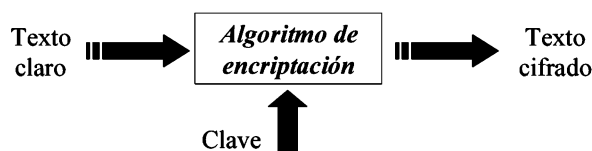
Figura 1.1. Esquema del proceso de cifrado
